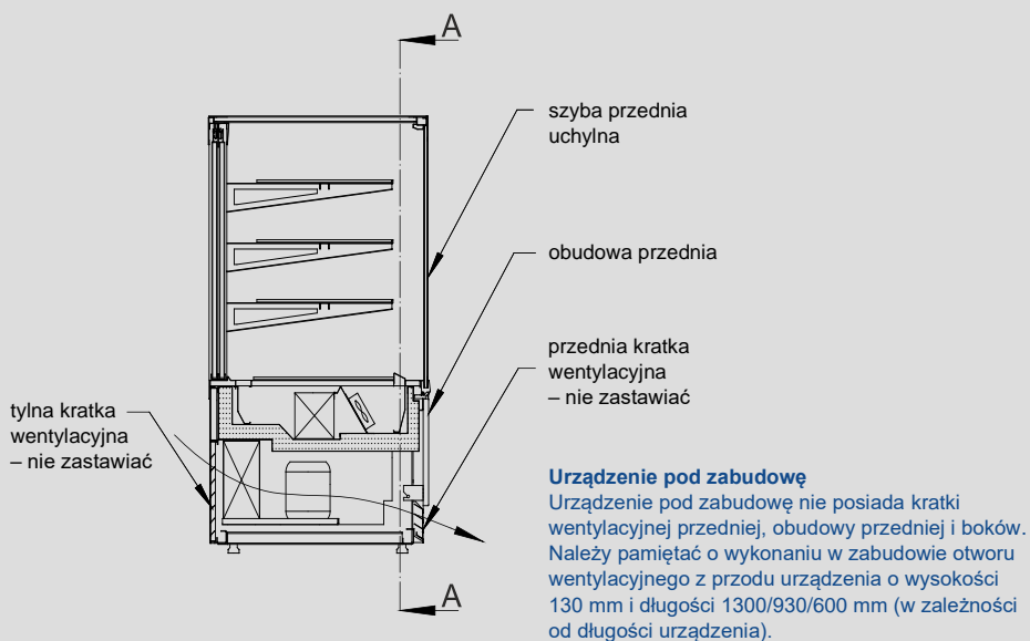
Rys. 3. Przekrój poprzeczny – przepływ powietrza
