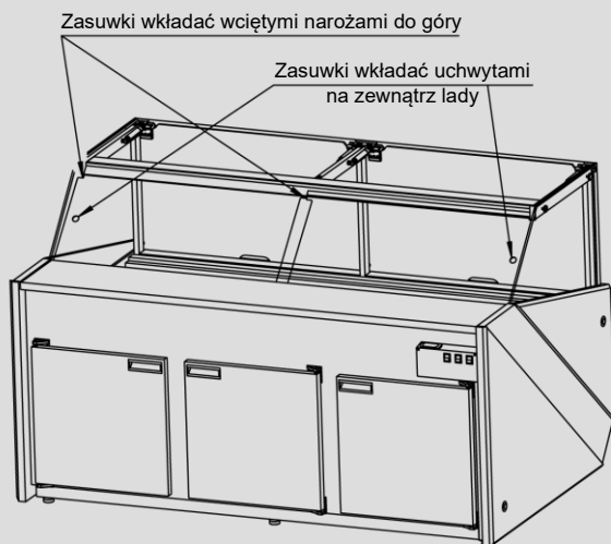
Rys. 8. Prawidłowe ułożenie zasuwek w prowadnicach. Lada L-X.
